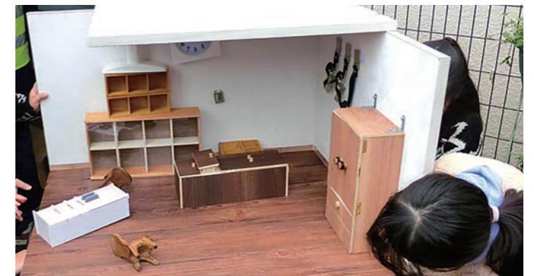
「家具転倒防止器具のミニチュア実験模型」 (ミニチュア家具を作って、実際に倒れる様子を体験できます) *台が左右前後に動くようになっています
