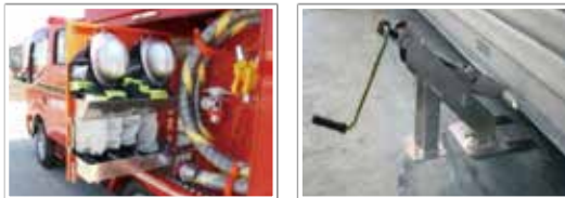
消防団の受賞作品例(左:防火衣等収納システムの開発、 右:簡易式万能ジャッキの改良)
