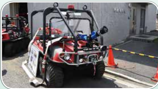
消火機能を付加した水陸両用バギー
